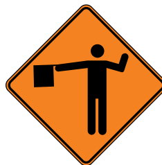
Signal avancé d'un signaleur
